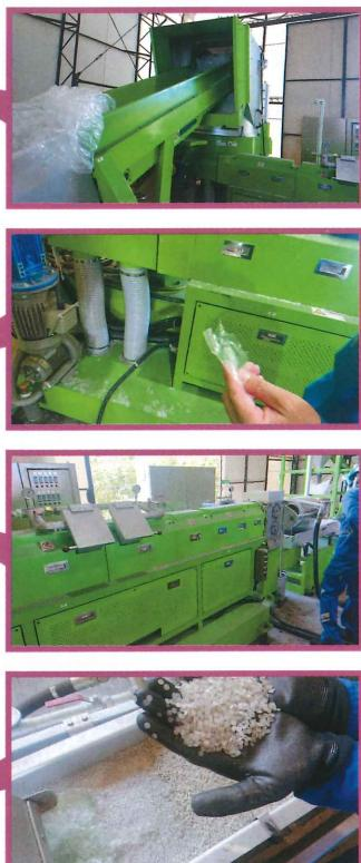
バージンペレットと再生ペレットをブレンドしブロー成形でポリ容器に成形します。
