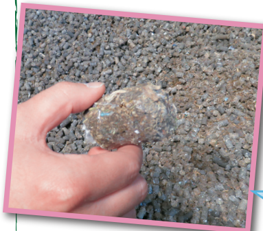
製造されたRPF。廃プラスチックの割合は約50%、生産量は約1400t/月に上るという。
