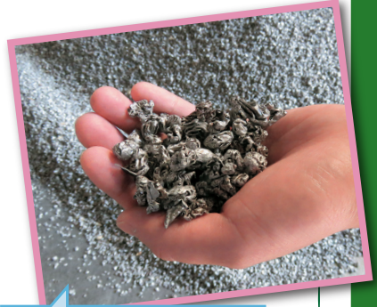
アルミ缶はアルミペレット化され精銅工場の脱酸剤として出荷
