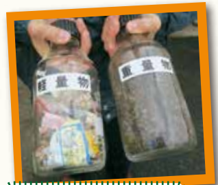
前処理工程において得られた分別後のごみの形状 左)軽量物 右)重量物
