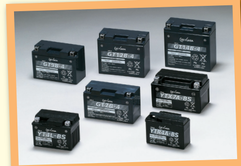
補水不要のバッテリー製品。寿命まで液面点検や補水の必要が無いため、注液口がありません。
