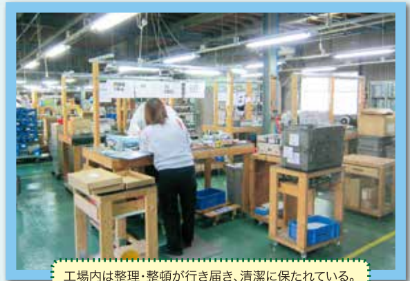
工場内は整理・整頓が行き届き、清潔に保たれている。木製の机は電気を通さない為の工夫。木製のため再利用もし易く廃棄物にならない利点も。
