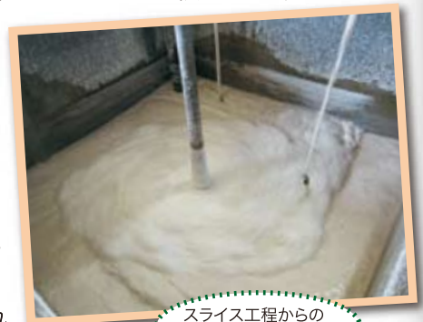
スライス工程からのでんぷんを含む排水
