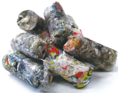
製造された固形燃料=RPF。 リングダイ方式(L50mm、φ10-15mm)(写真)とスクリュウ方式(L100mm、φ30mm)がある。 発熱量5,000~7,500kcal/kg、灰分5%以下、塩素分0.2%以下。 原料は廃プラ60-70%、紙くず等30-40%、 製造能力はリングダイ式が613m 3 /日、スクリュウ式が240m 3 /日。
