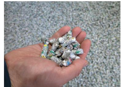
固形燃料：燃料としての質を高めるためには、カロリー調整とともに塩素(塩化ビニール)の除去が不可欠だ
